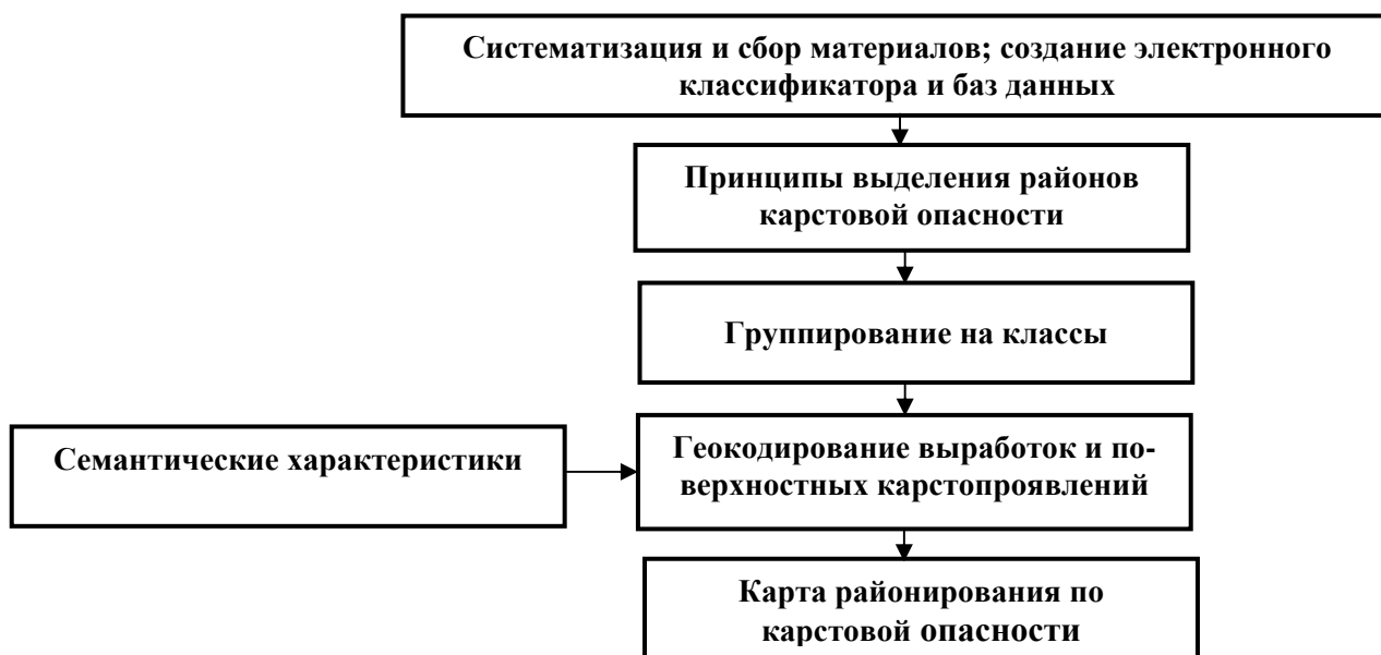
Рис. 5. Технология построения информационной модели пространственного прогноза карстоопасности
