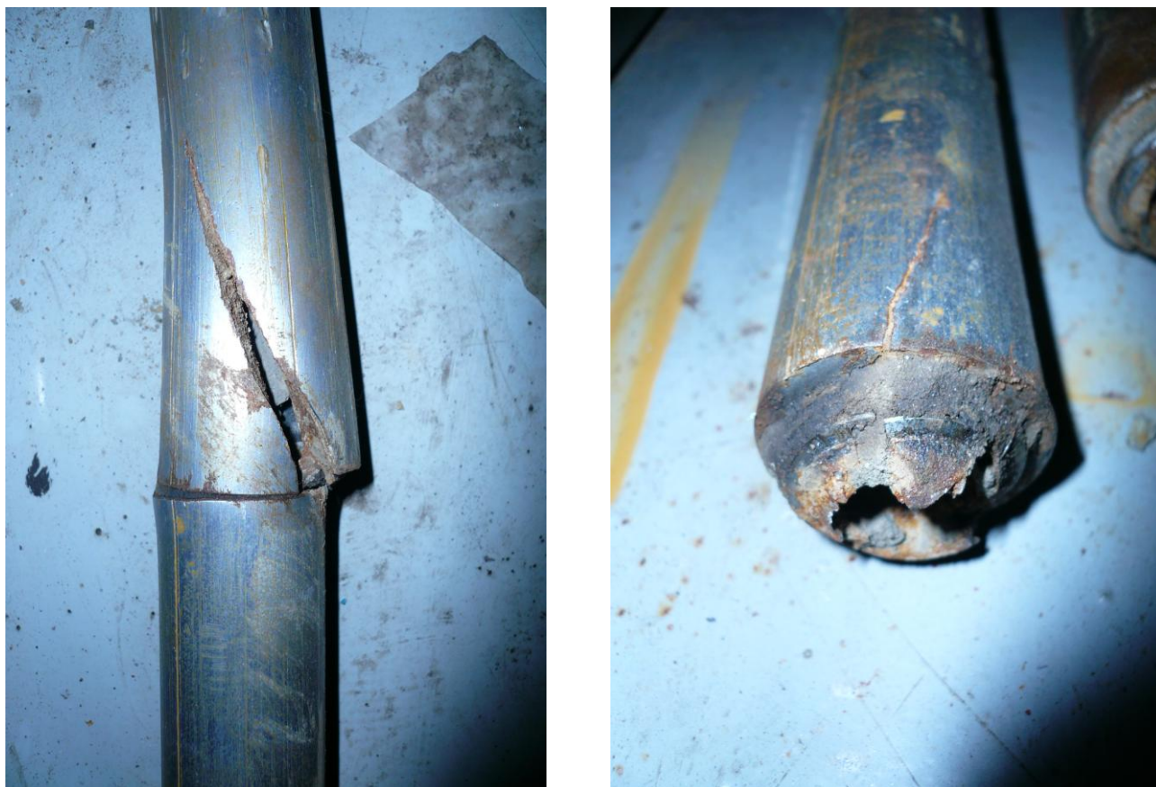
Рис. 5 Результат искривление ствола зондировочных скважин:
