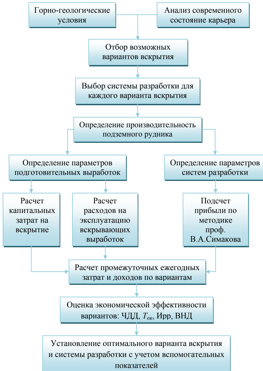
Рис. 5. Схема оптимизации комбинированной геотехнологии при переходе от открытых к подземным горным работам.
