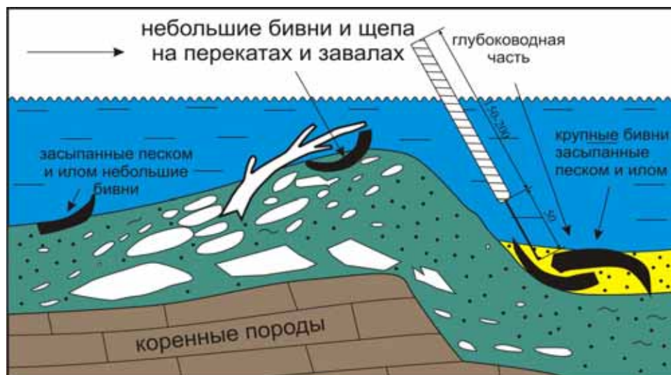
Рис. 6. Схематический профиль реки и благоприятные места залегания ИМК на дне и их обнаружение при помощи щупа.
