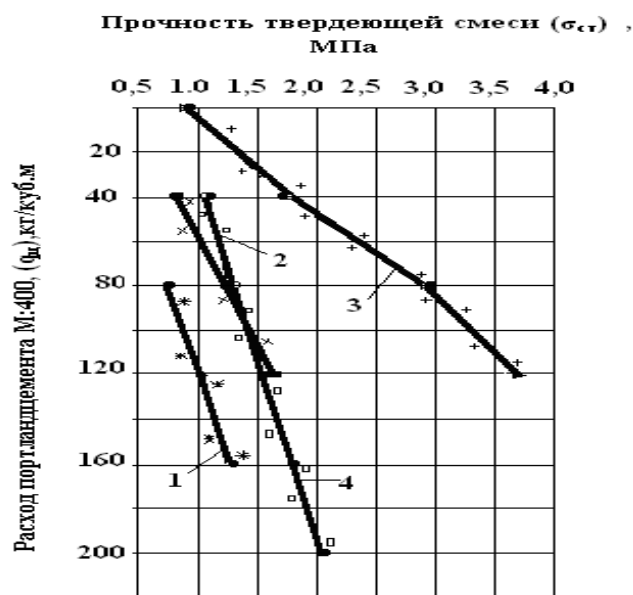
Рис. 1. Зависимость прочности закладки в образцах от расхода портландцемента М:400 при твердеющей смеси: 1- с мелким заполнителем на цементном вяжущем компоненте; 2- то же на цементно-шлаковом вяжущем компоненте; 3- с крупным заполнителем на цементно-шлаковом вяжущем компоненте; 4 - с очень мелким заполнителем на цементно-шлаковом вяжущем компоненте.
