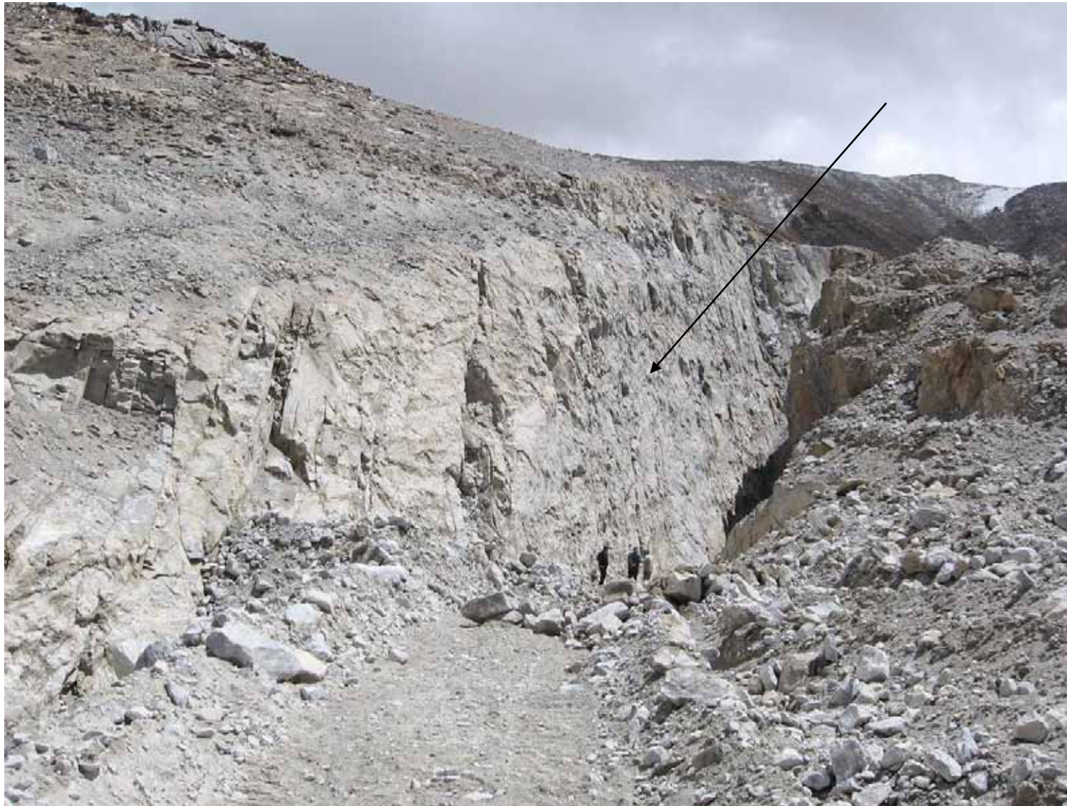
Рис. 7. Карьер на месторождении Снежное, 2008 год. Слева видна поверхность напластования (указана стрелкой), контролирующая размещение Верхней продуктивной зоны
